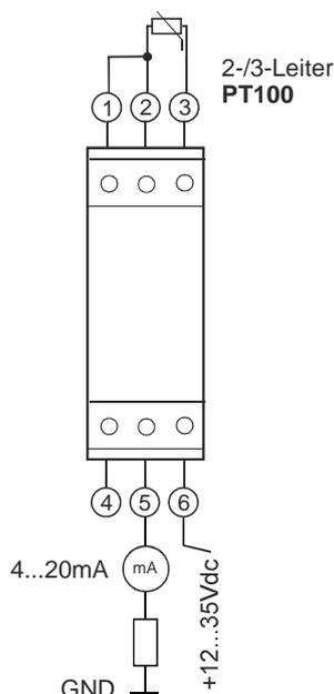
Der Ausgangsstrom folgt linear dem am Eingang anliegenden Temperatursignal. Der Abgriff des Ausgangssignals erfolgt in Reihe zwischen den Klemmen 5 und 6. Zwischen dem Sensor und der Versorgungs- bzw. Ausgangsstrom darf keine galvanische Trennung bestehen.
